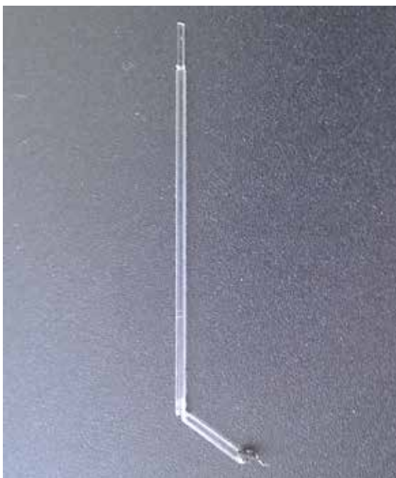
Рис. 3.20. Излом на фото — место фиксации крючка, ниже — оплавленная оплетка в месте первичного повреждения кварцевого волокна
