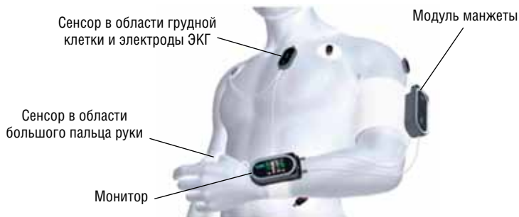
Рис. 6. Системы CNAP (сверху) и Sotera's ViSi Mobile System (снизу) для удаленного мониторинга артериального давления. Источник: www.cnsystems.at и http://www.lasplash.com/publish/Hardware_Reviews_and_News_129/visi-mobile.php
