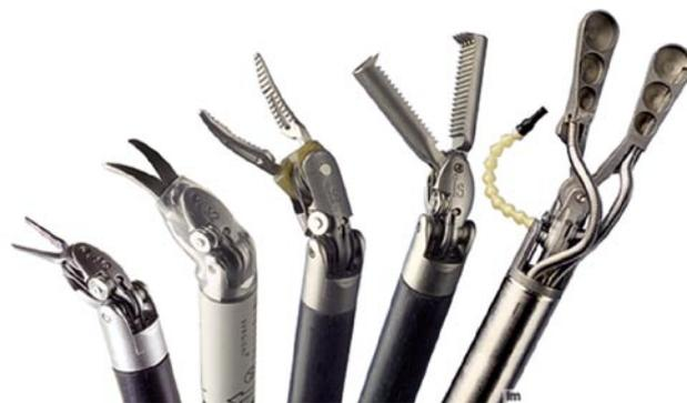
Рис. 3. Роботические инструменты EndoWrist
