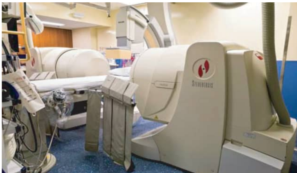
Рис. 24.18. Роботизированная система NIOBE (Stereotaxis, США)
