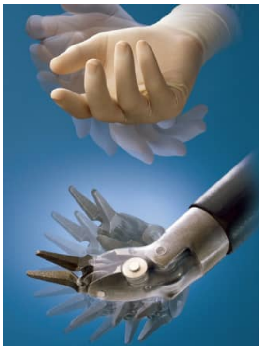
Рис. 24.16. Сравнение кисти руки и инструментария роботизированного хирургического комплекса по степеням свободы движений (объяснение в тексте); размер рабочей части манипулятора 8 мм
