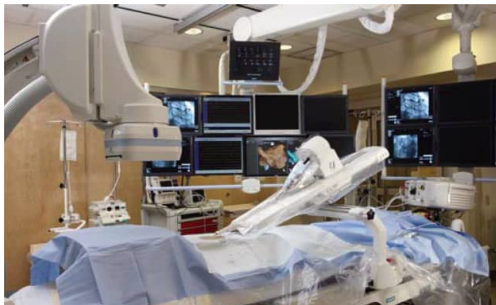
Рис. 24.21. Система удаленного контроля и позиционирования катетеров AMIGO (Catheter Robotics, Inc., США)
