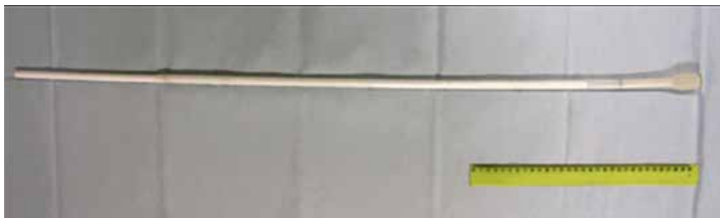
Рис. 7. Доставочное устройство с частично сложенным полимерным саморасширяющимся стентом из силикона с полиэфирной сеткой
