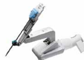
РИС. 34. МАНИПУЛЯТОР СО СЪЕМНЫМ ИНСТРУМЕНТОМ
