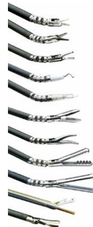
РИС. 33. ОСНОВНЫЕ ИНСТРУМЕНТЫ СИСТЕМЫ DA VINCI
