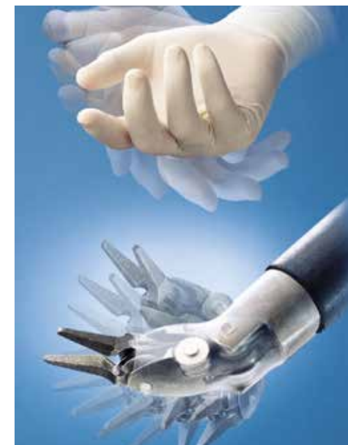
Рис. 6. СРАВНЕНИЕ ЧИСЛА СТЕПЕНЕЙ СВОБОДЫ У ЧЕЛОВЕЧЕСКОЙ РУКИ И РОБОТИЗИРОВАННОГО МАНИПУЛЯТОРА
